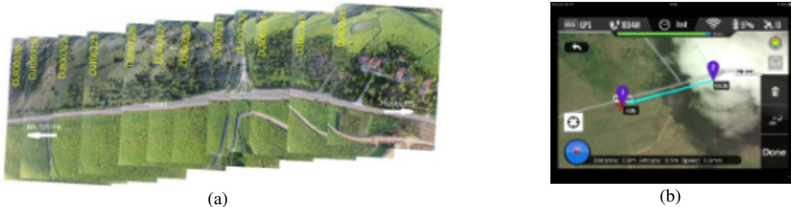
Figura 7 – (a) Vista da aeroimagem no formato de fotoíndice da Faixa 1 de voo (b). Vista do programa DJI Vision no módulo *GroundStation* mostrando faixa de vôo 1
